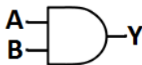
Slika 2.1 Logička vrata I - simbol (Izvor:[4]).
