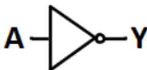
Slika 2.3 Logička vrata NE - simbol (Izvor: [4]).
