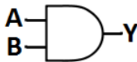
Slika 2.1 Logička vrata I - simbol (Izvor:[4]).
