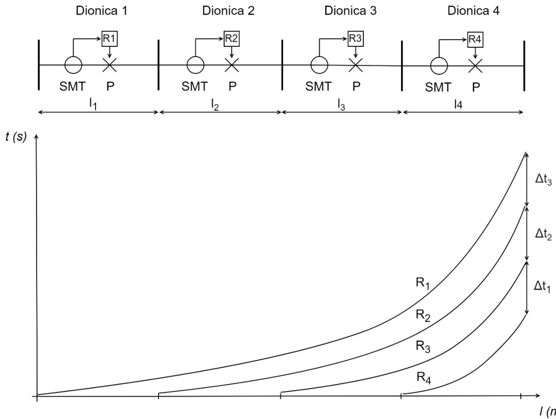
Slika 3.7 Primjer pravilnog stupnjevanja inverznih releja za radikalnu distribucijsku mrežu u kojoj svaki vod ima vlastitu zaštitu
