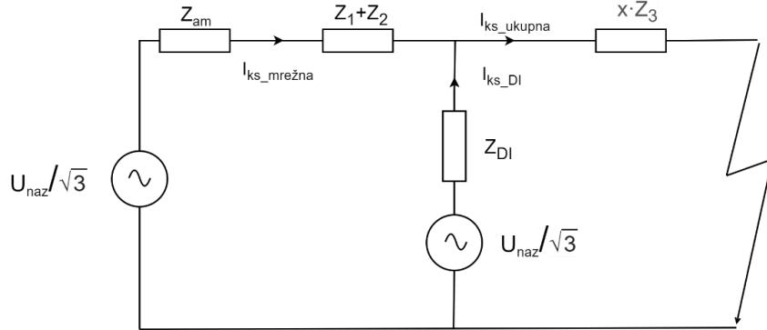
Slika 3.13 Izračun mrežne komponente struje kratkog spoja
