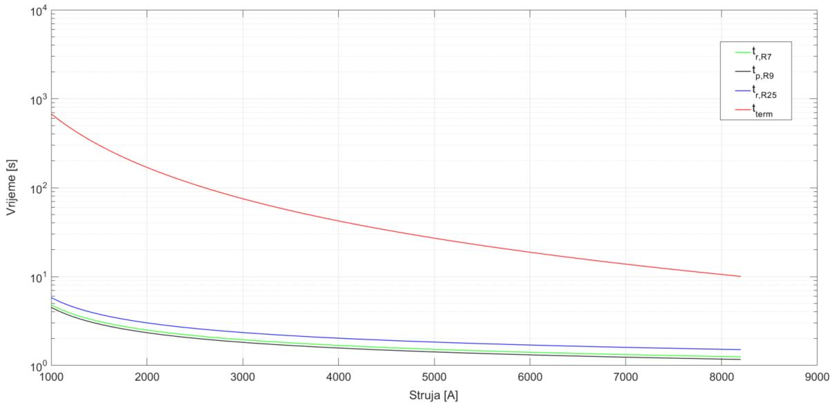
Slika 7.16 Inverzne karakteristike za primarni relej R9 i rezervne releje R7 i R25, prikazane uz termičku krivulju štićenog voda (5)
