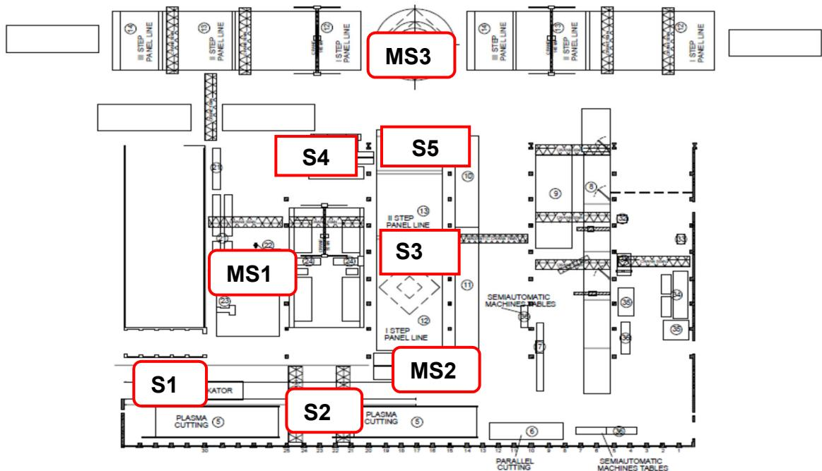
Slika 5.2 Tlocrt radionice za izradu ukrijepljenih panela
