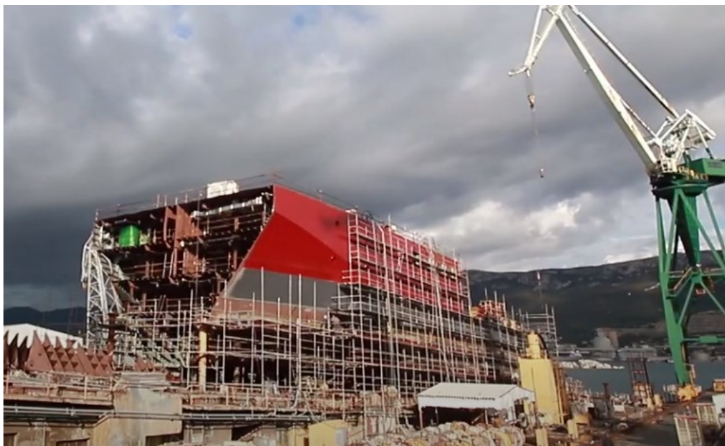
Slika 6.1.1. Montaža brodskog trupa na navozu (Brodosplit)
