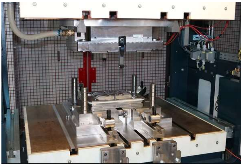
Slika 3.1. Hidraulična preša sa grijanim alatom
