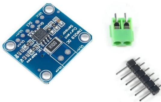
Slika 9: INA219 modul za mjerjenje struje
