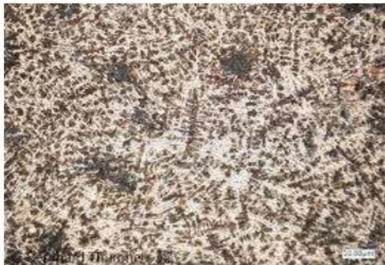
*Slika 3.8. Ledeburitna mikrostruktura [5]*
