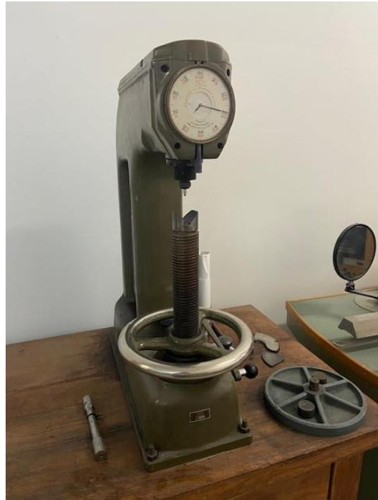
Slika 9.7. Uredaj za mjerenje tvrdoće (HRC)
