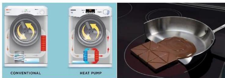
*Slike 2.22. i 2.23.: sušilica s toplinskom pumpom, indukcijska ploča [4]*
