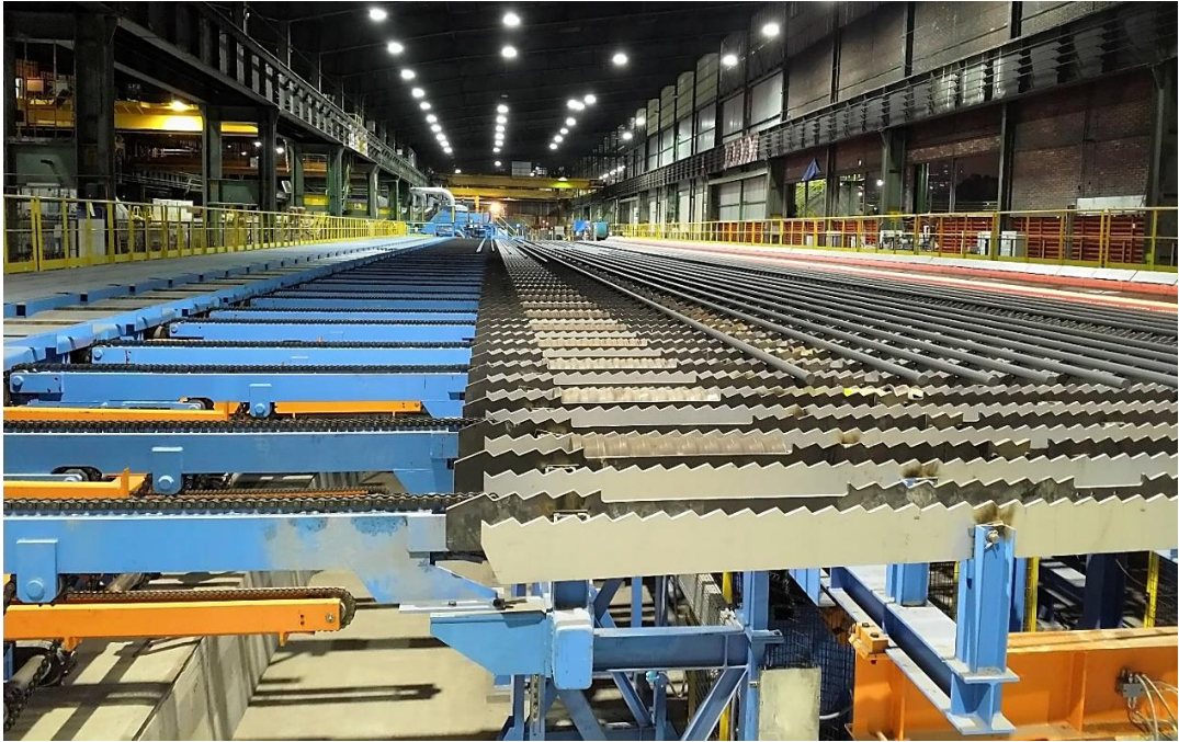
Slika 3.6. Podij za hlađenje materijala [autor]
