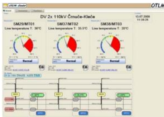
Slika 6.4. Alarmi u OTLM Center [31]
