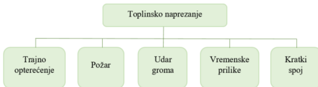
Slika 2.2. Uzroci toplinskog naprezanja [4]
