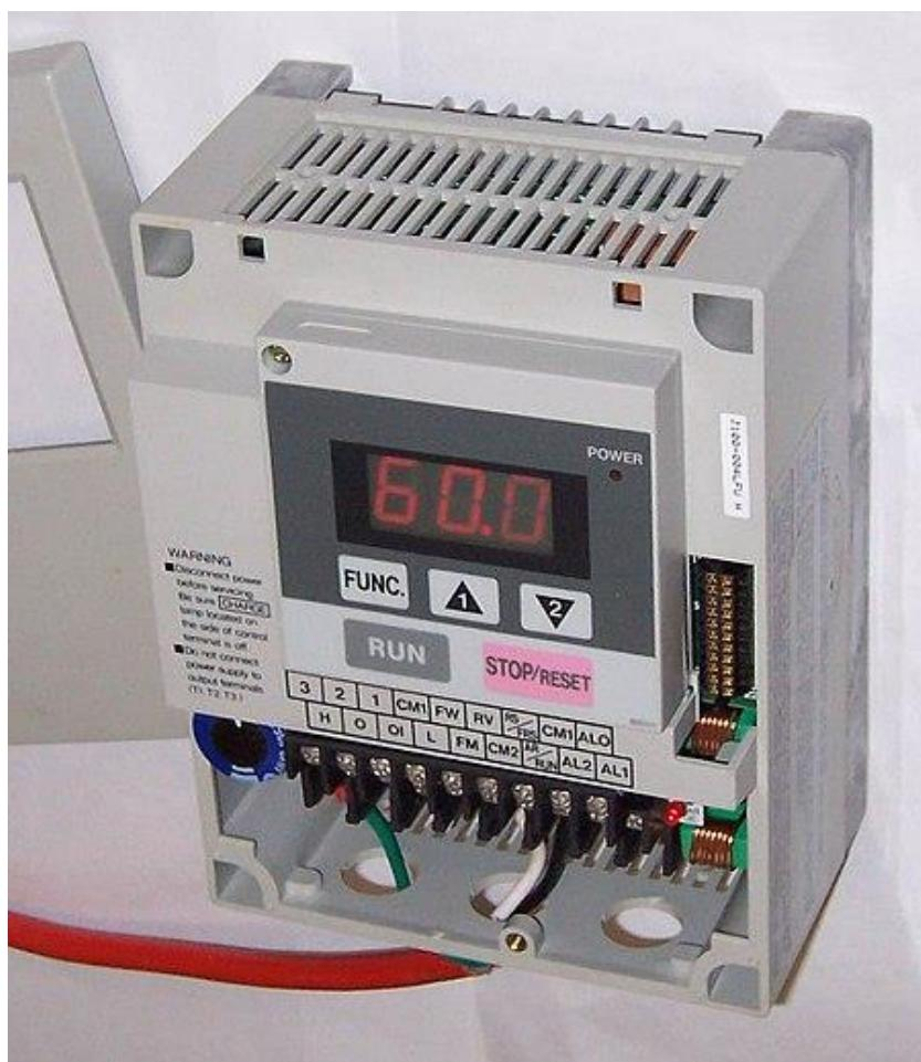
Slika 2.8. Frekventni pretvarač (VFD) [20]
