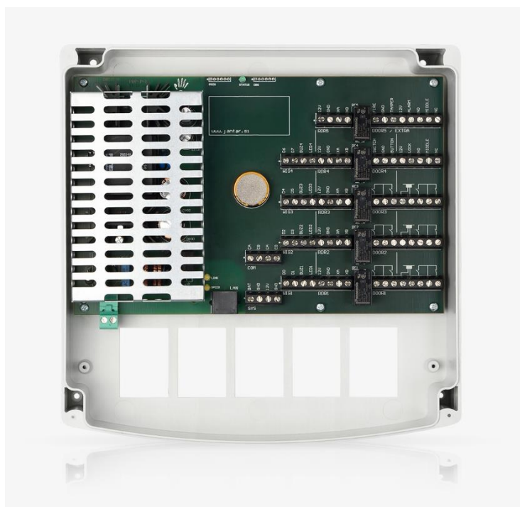
Slika 2.10. Kontroler za 4 vrata [18]
