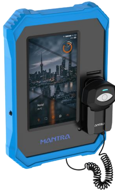
Slika 3.7. Uređaj za prepoznavanje šarenice oka [53]
