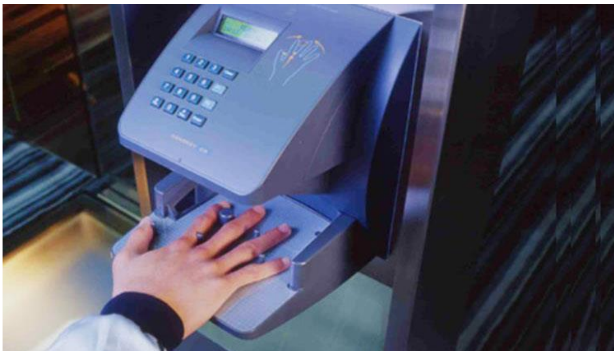
Slika 3.5. Uređaj za skeniranje geometrije ruke [46]
