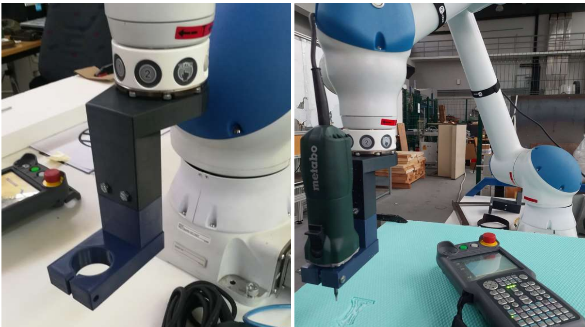
Slika 4.10. Montiranje prihvatnice i Metabo motor-vretena.
