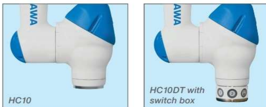
Slika 3.10. Prikaz robota sa i bez DT modula [30].
