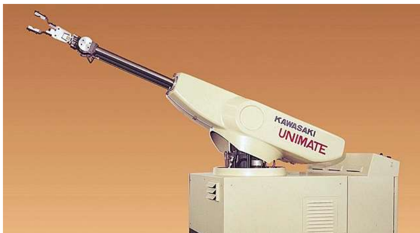
Slika 2.2. Prikaz robota prve generacije [8].
