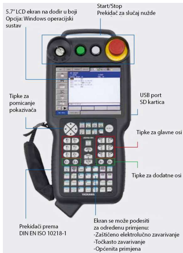
Slika 3.12. PHG (ručna programska jedinica) i funkcije tipki [31].
