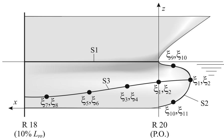
**Slika 5.3.** Opisivanje geometrije bulba pomoću napetog splajna
