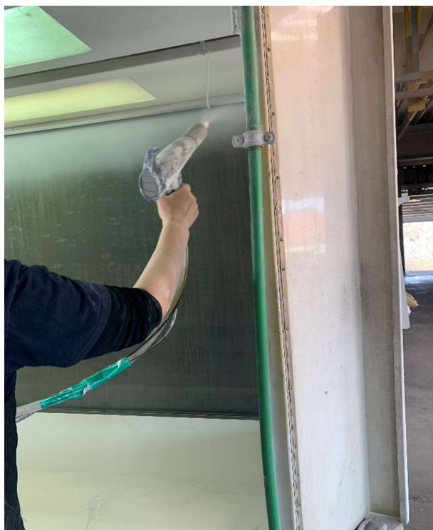
Slika 6.12: Postupak nanošenja praha
