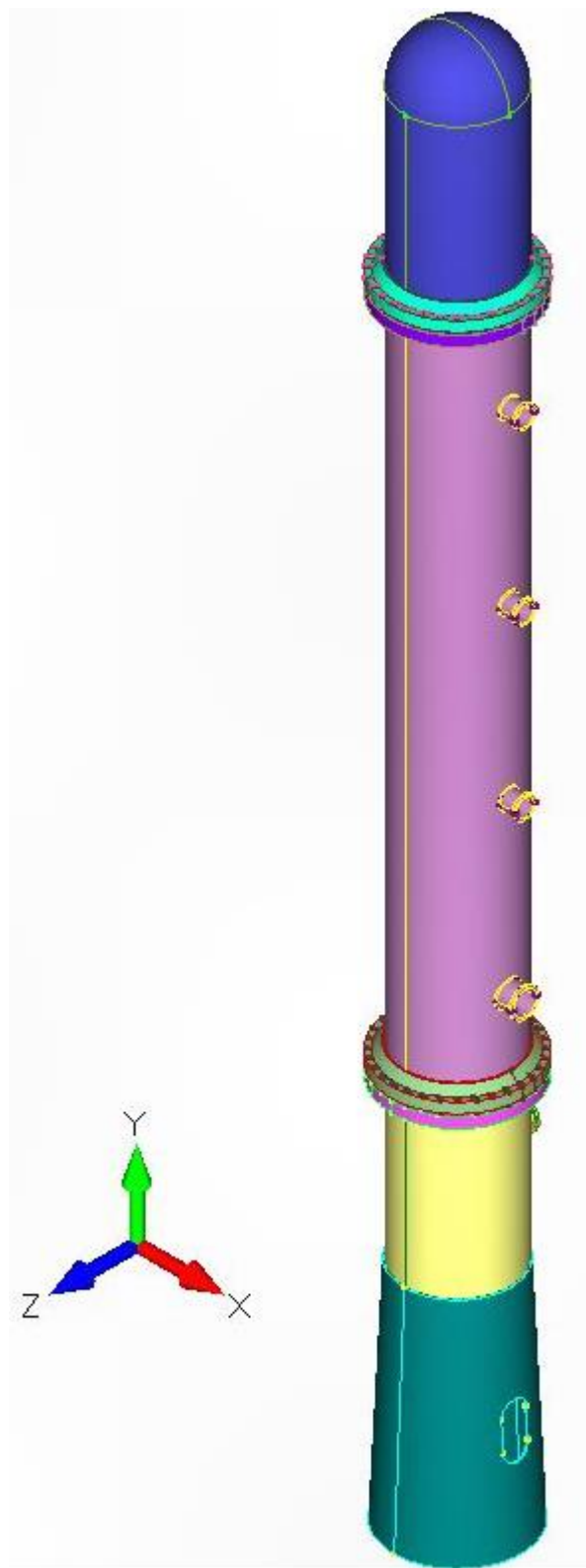
Slika 4.1 Model kolone unutar programa Femap
