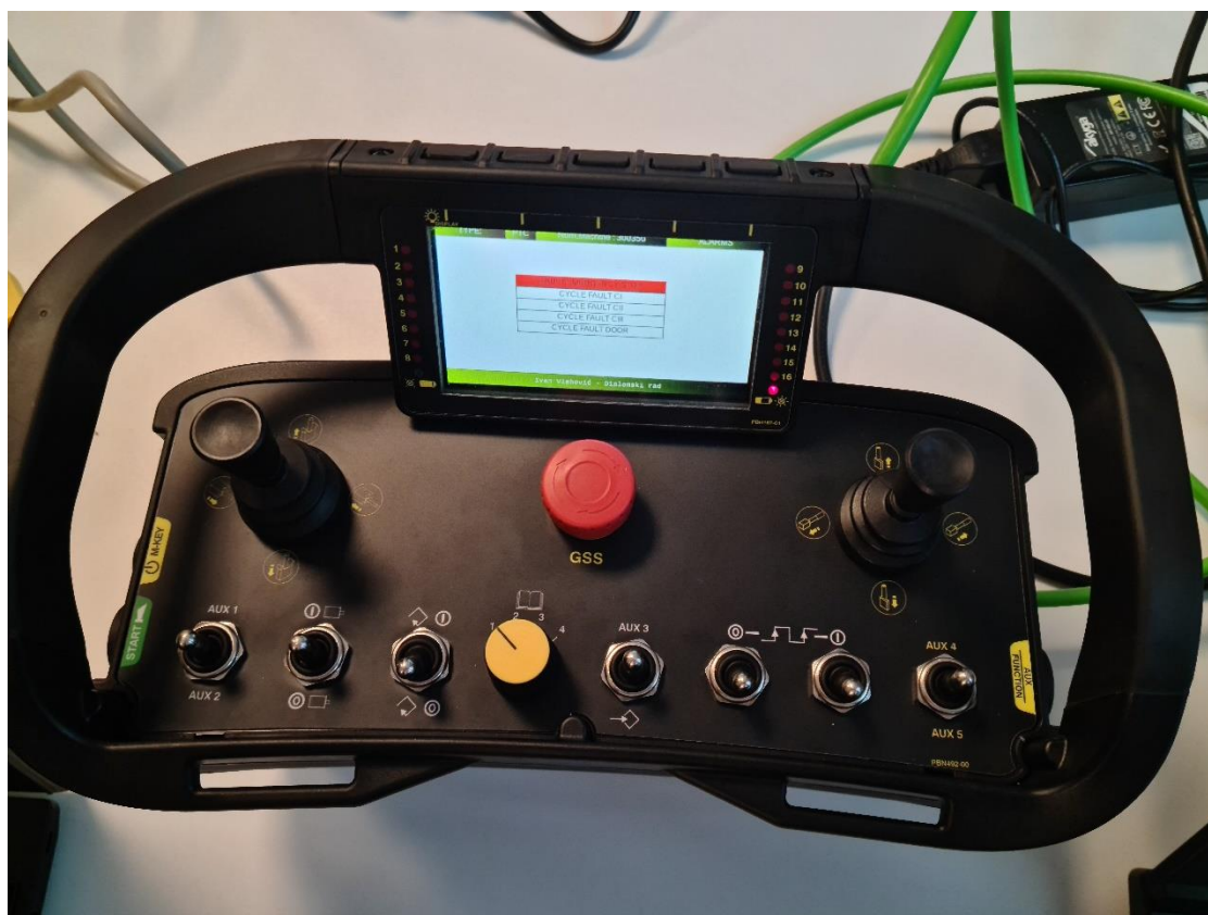
Slika 6.6. Stranica alarma na radio odašiljaču
