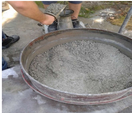
Slika 30 Betonska mješavina s 1% zamjene otpadnog LCD 10
