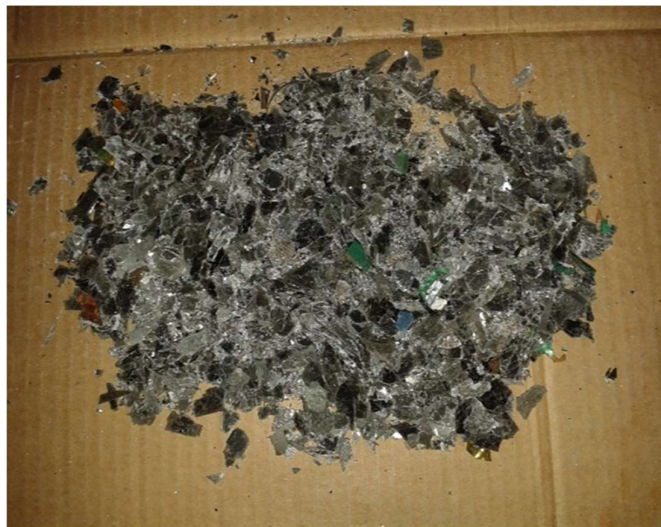
Slika 17 Usitnjeni LCD zasloni na 10 mm
