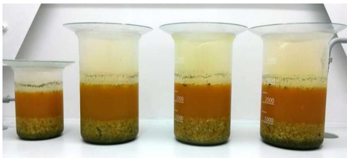
Slika 20 Uzorak LCD-a u zlatotopci nakon 48 sati
