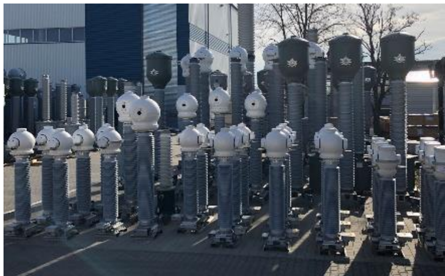
Slika 3.15. Strujni transformatori izolirani SF 6 [13]
