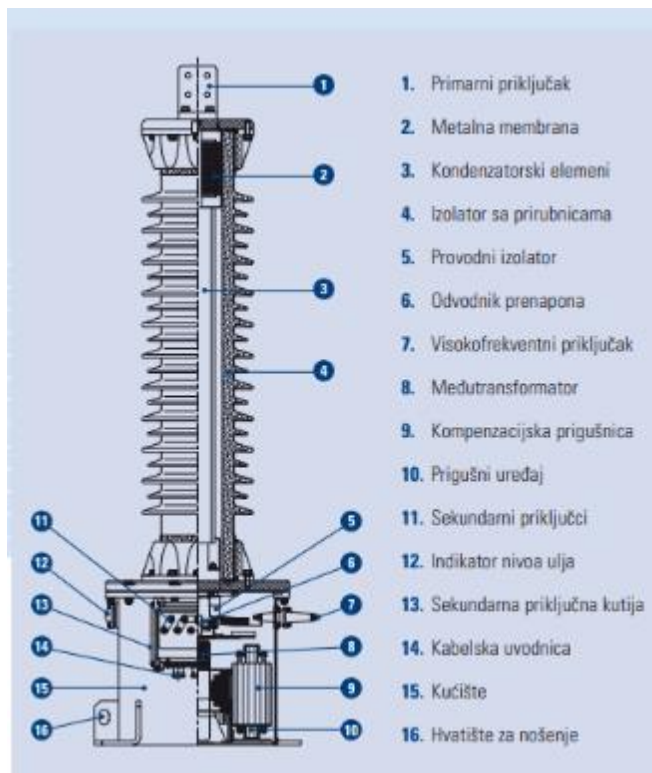
Slika 3.29. Kapacitivni mjerni transformator izoliran papirno uljnom izolacijom [21]
