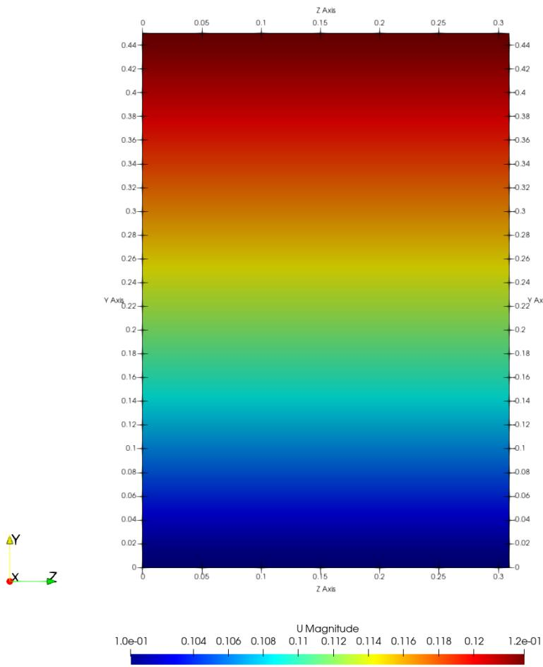
Slika 5.5. Profil brzine na ulaznom licu
