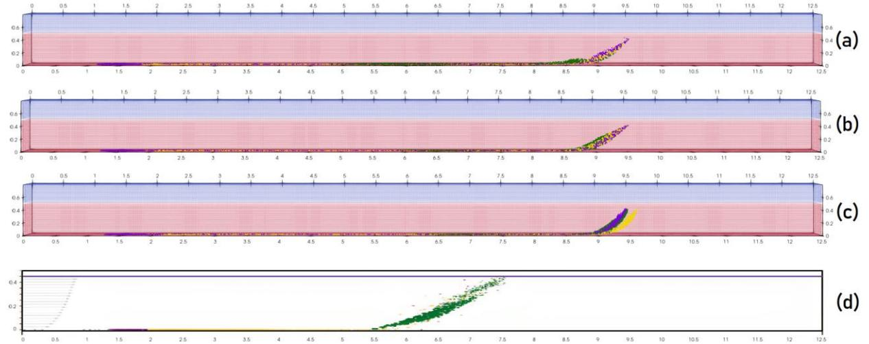
*Slika 6.7. Usporedba numeričkih rezultata taloženja čestica mikroplastike u trenutku  $t_3$ : a)laminarni model; b)kOmega turbulentni model; c)kEpsilon turbulentni model; d)Python numerički model*
