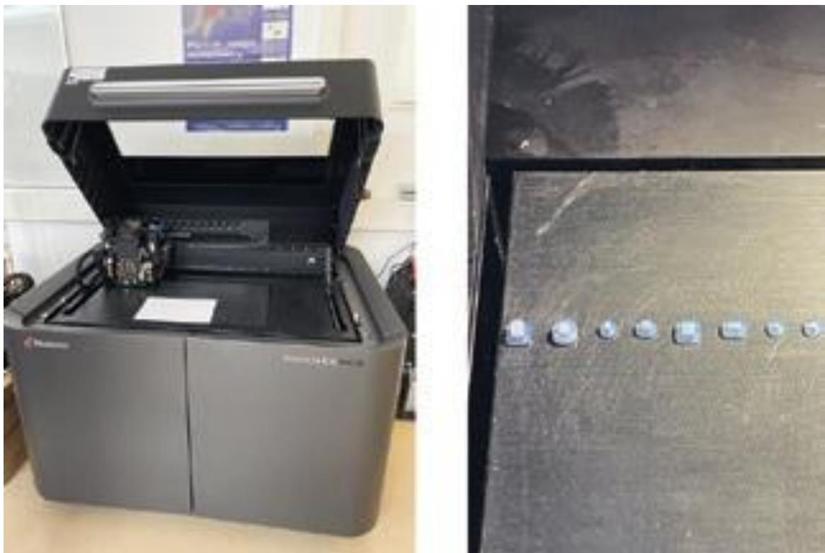
Slika 5.1. 3D printer kojim će se izvršiti priprema uzoraka čestica mikroplastike (1D, 2D i 3D čestice – desna slika, bijeli dio su čestice, plavi dio je baza koje se inspiri) [4]
