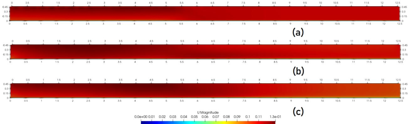
Slika 6.2. Usporedba polja brzina u trenutku  $t=50s$  između numeričkih modela: a)laminarni model, b)kOmega turbulentni model, c )kEpsilon turbulentni model
