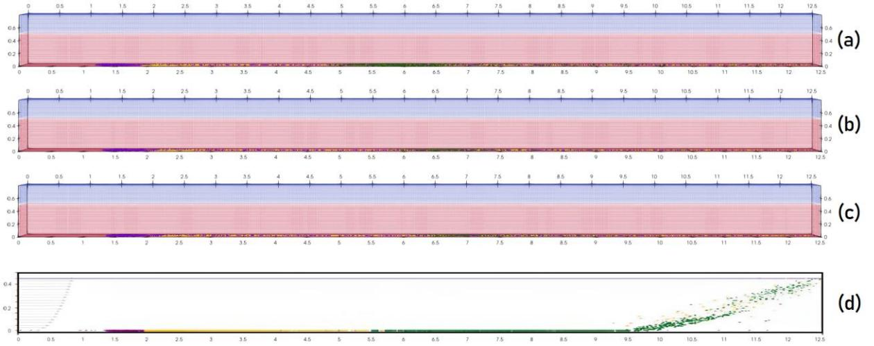
Slika 6.9. Usporedba numeričkih rezultata taloženja čestica mikroplastike u trenutku  $t_5$ : a)laminarni model, b)kOmega turbulentni model, c)kEpsilon turbulentni model, d)Python numerički model
