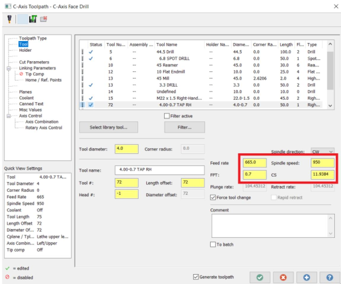
Slika 100 Postavke obrade urezivanja navoja M4 - zahvat 12, operacija 10
