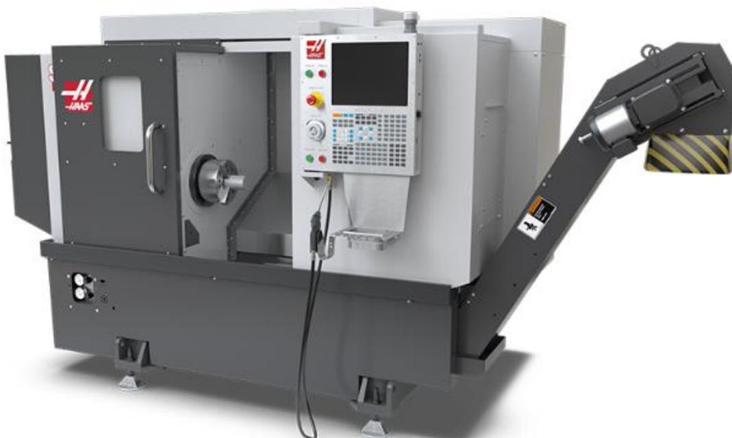
*Slika 25 CNC tokarski obradni centar HAAS-ST-10*
