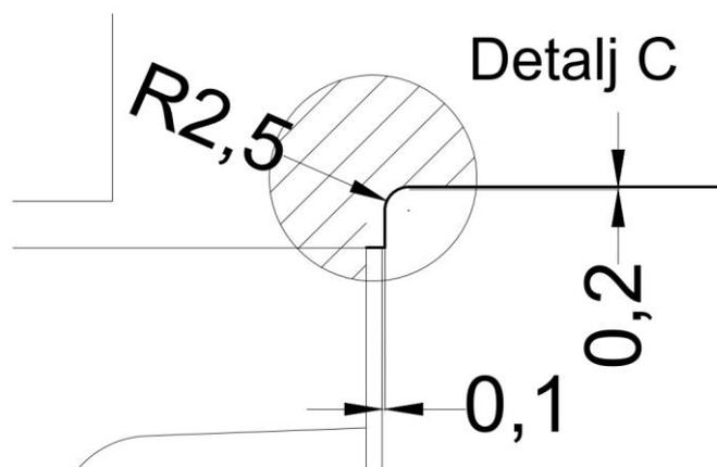
Slika 9 Detalj C s dodacima za obradu brušenjem
