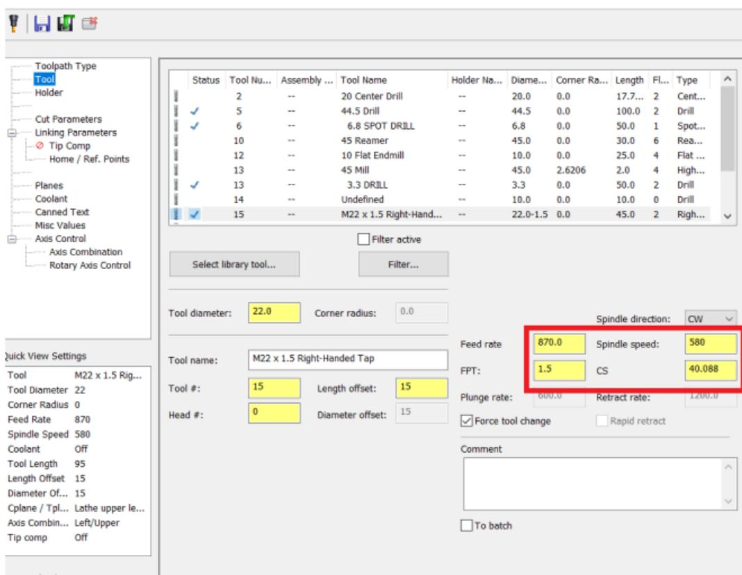
Slika 102 Parametri alata - zahvat 13, operacija 10
