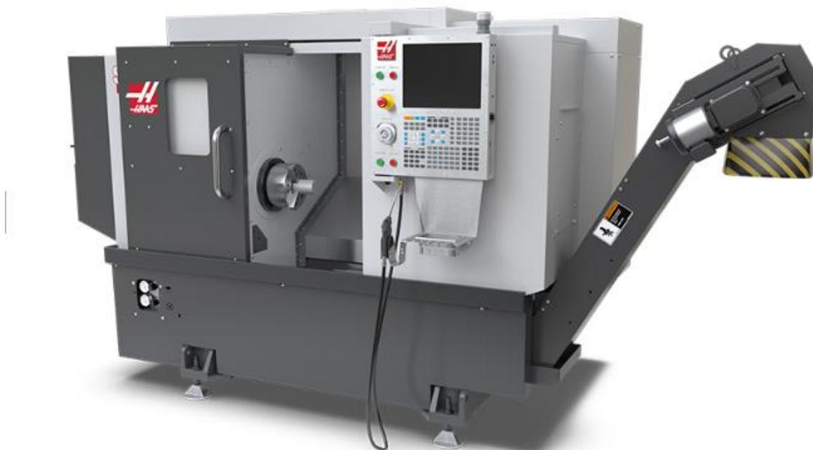
Slika 1 CNC tokarski obradni centar HAAS-ST-10 [2]
