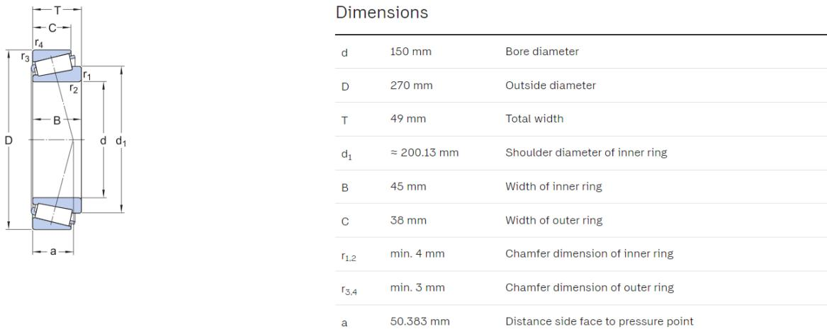
Slika 5.2. SKF 30230 - ležaj planetarnog prijenosnika unutar kućišta plp-a [8]
