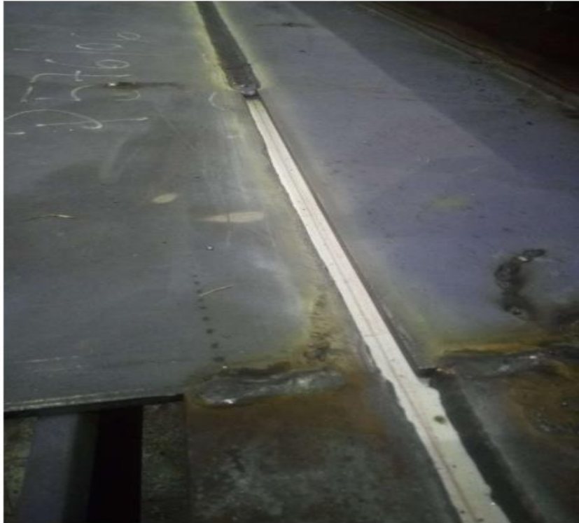
Slika 8.4. 2: Priprema za sučeljni spoj
