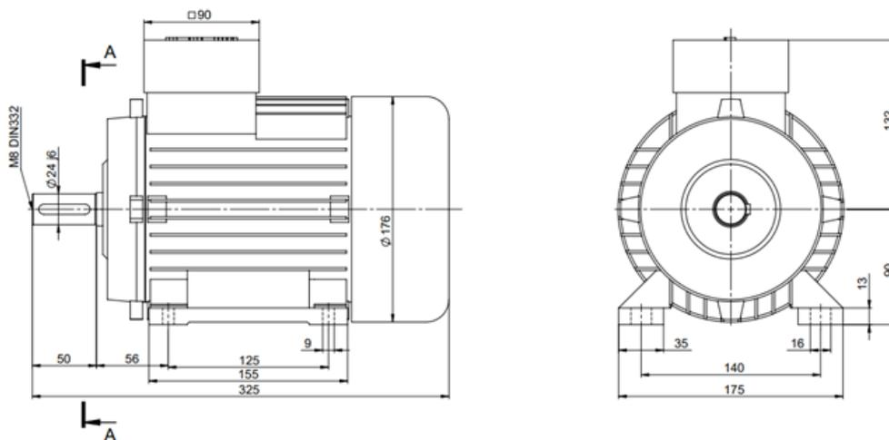
Slika 6.4. Dimenzije elektromotora [20]
