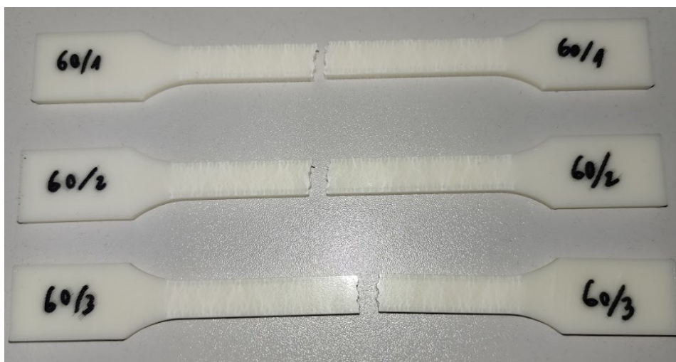
Slika 6.14 Pokidane epruvete s 60% ispune
