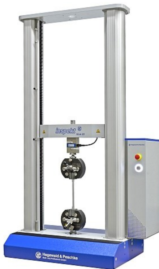
Slika 3.1 Izgled tipične kidalice [19]
