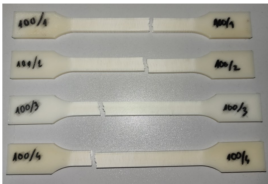
Slika 6.10 Pokidane epruvete sa 100% ispune
