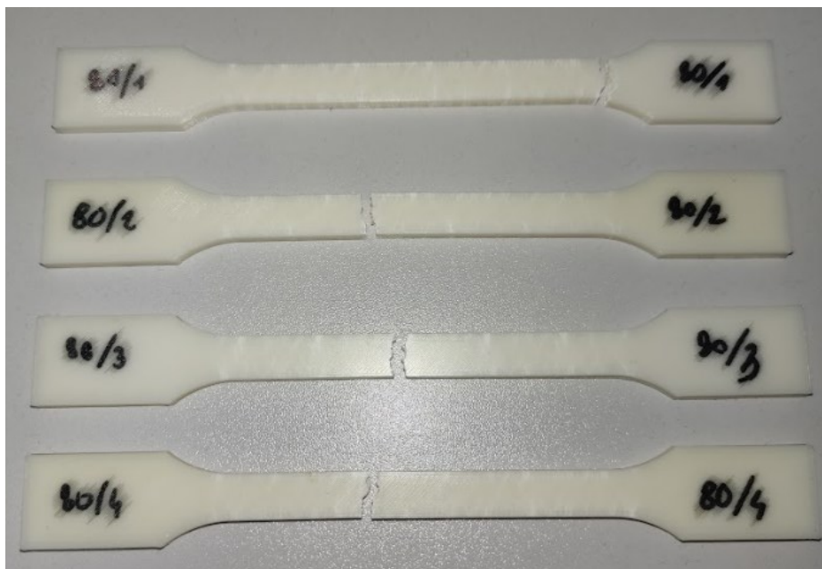
Slika 6.12 Pokidane epruvete s 80% ispune
