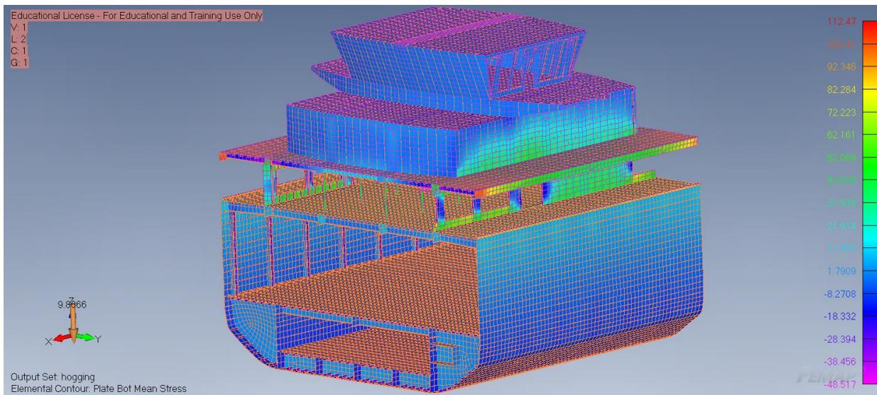
Slika 4.3.9 - Naprezanja strukture cijelog trajekta u pregibu
