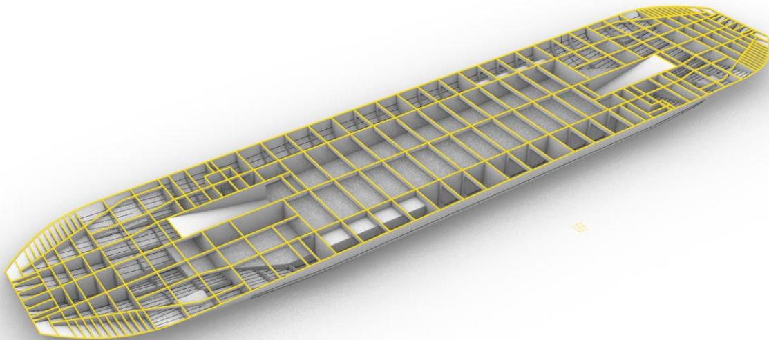
*Slika 2.2.4 - Računalni model strukture ispod glavne palube*
