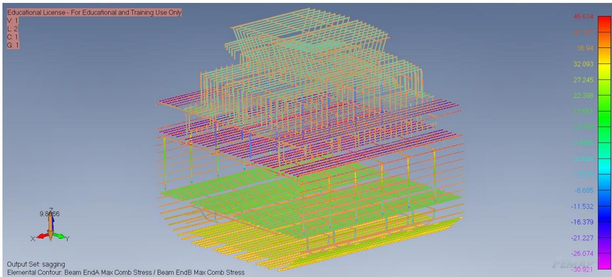
Slika 4.3.13 - Maksimalna naprezanja profila cijelog trajekta pri progibu
