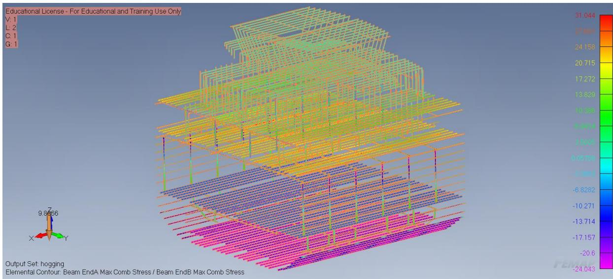
Slika 4.3.11 - Maksimalna naprezanja profila cijelog trajekta u pregibu
