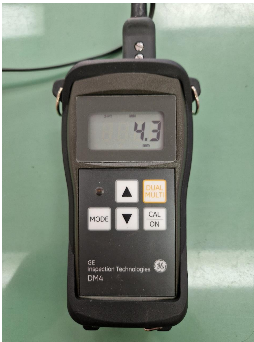
Slika 4.7.1 Rezultat mjerenja debljine cijevi ultrazvukom
