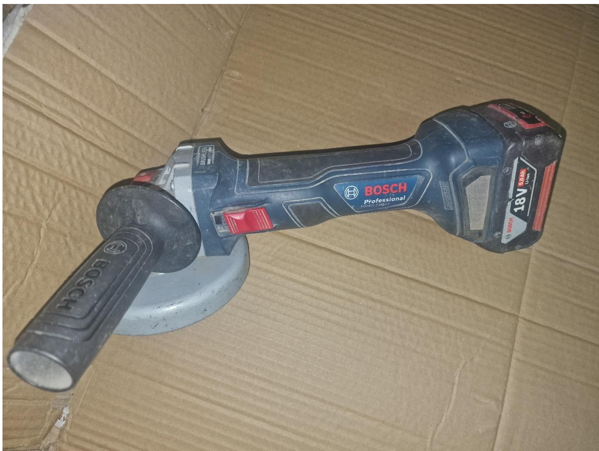
Slika 4.1 Ručna akumulatorska brusilica s BLDC motorom
