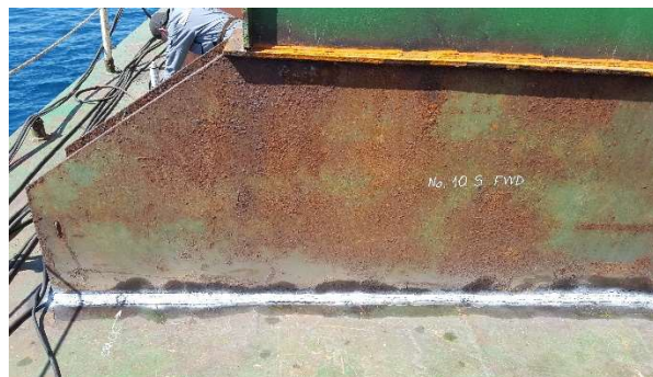
Slika 3.16. Ispitivanje zavara na bijeloj kontrastnoj podlozi
