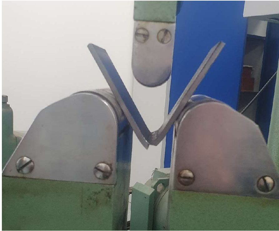
Slika 31 Pucanje uzorka 4 u kidalici
