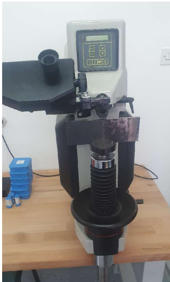
Slika 20 Uređaj za mjerenje tvrdoće zavara.
