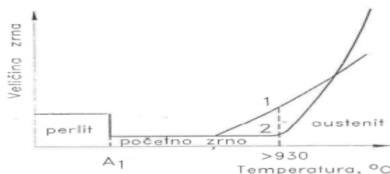
Slika 2.8. Promjena veličine kristalnog zrna austenita ovisno o temperaturi [1]
