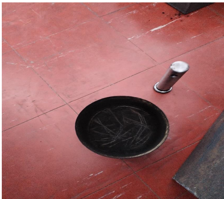
Slika 4.5. Posuda za pougljičavanje i strojni dio
