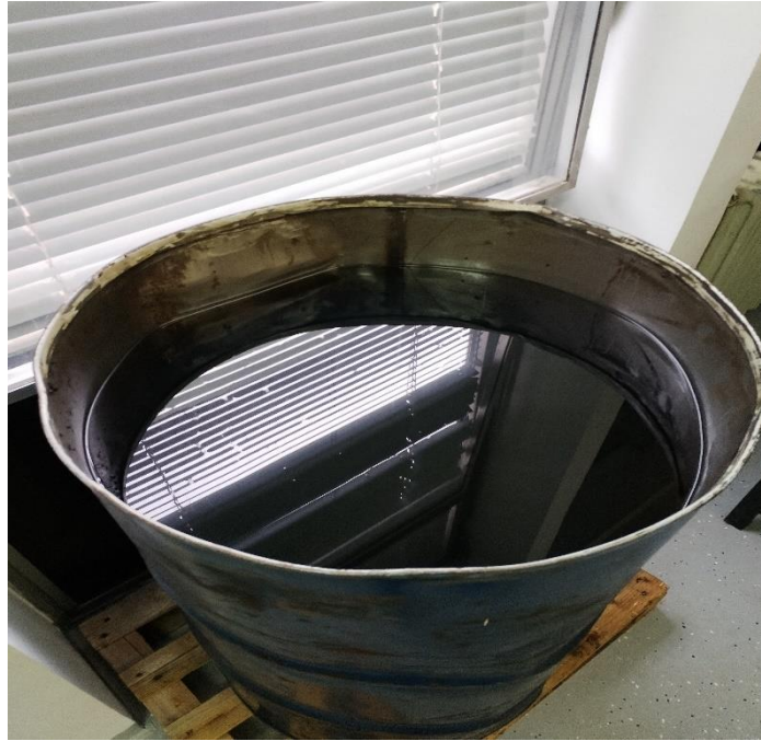
Slika 4.9. INA KALENOL 22 ulje za gašenje strojnog dijela
