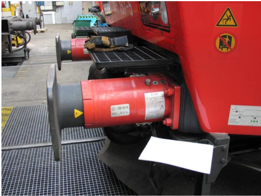
Slika 5.2 Prikaz odbojnika udara na željezničkom vagonu [9]
