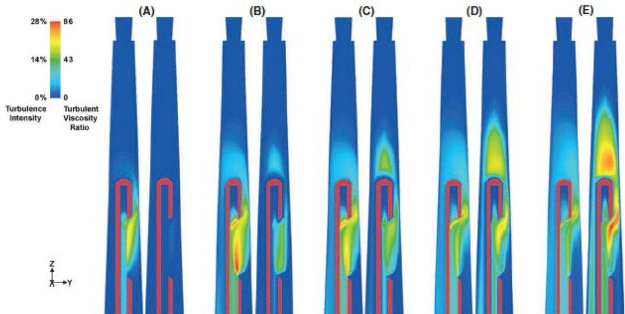
Slika 3.2 Ispitivanje strujanja fluida za različite protoke fluida [6]
