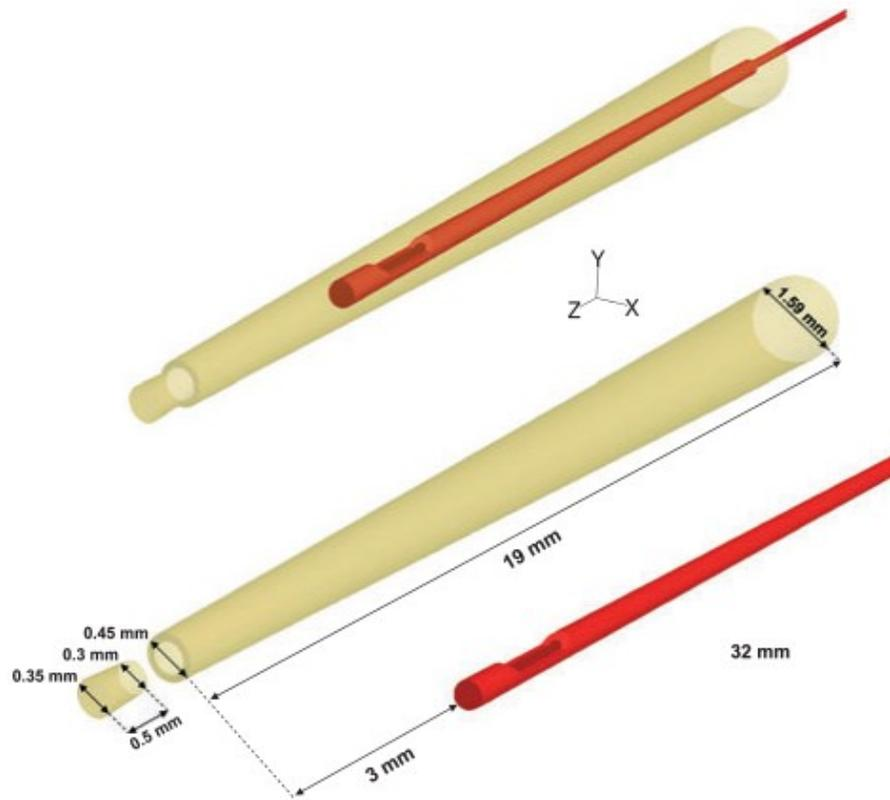
Slika 4.1 Geometrijske karakteristike modela zubnog kanala [6]
