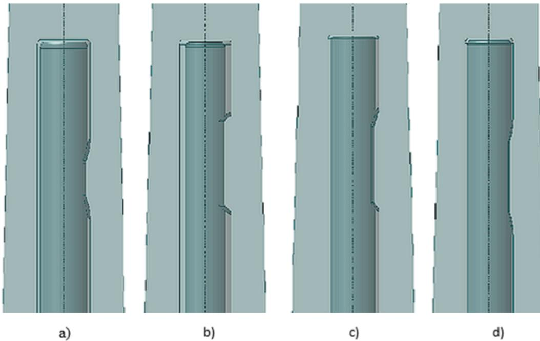
Slika 8.2 Izmjene dimenzija otvora prve geometrije irigacijske igle
