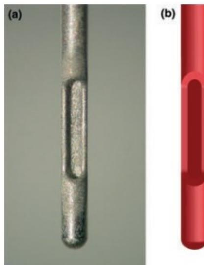
Slika 4.4 Usporedba igle s modeliranom geometrijom [6]
