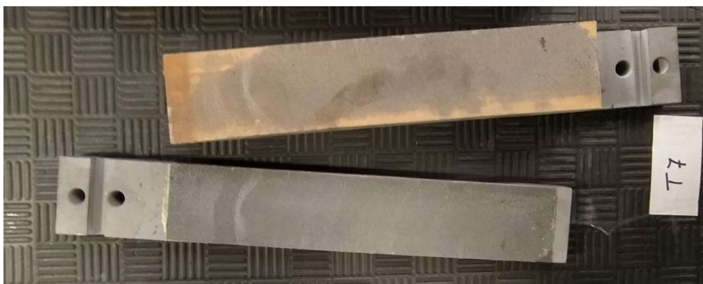
Slika 3.23 Prikaz uzoraka T7 nakon izvođenja ispitivanja, te prikaz ostataka ljepila na čeličnoj ploči i jezgri od pjenastog polimera.
