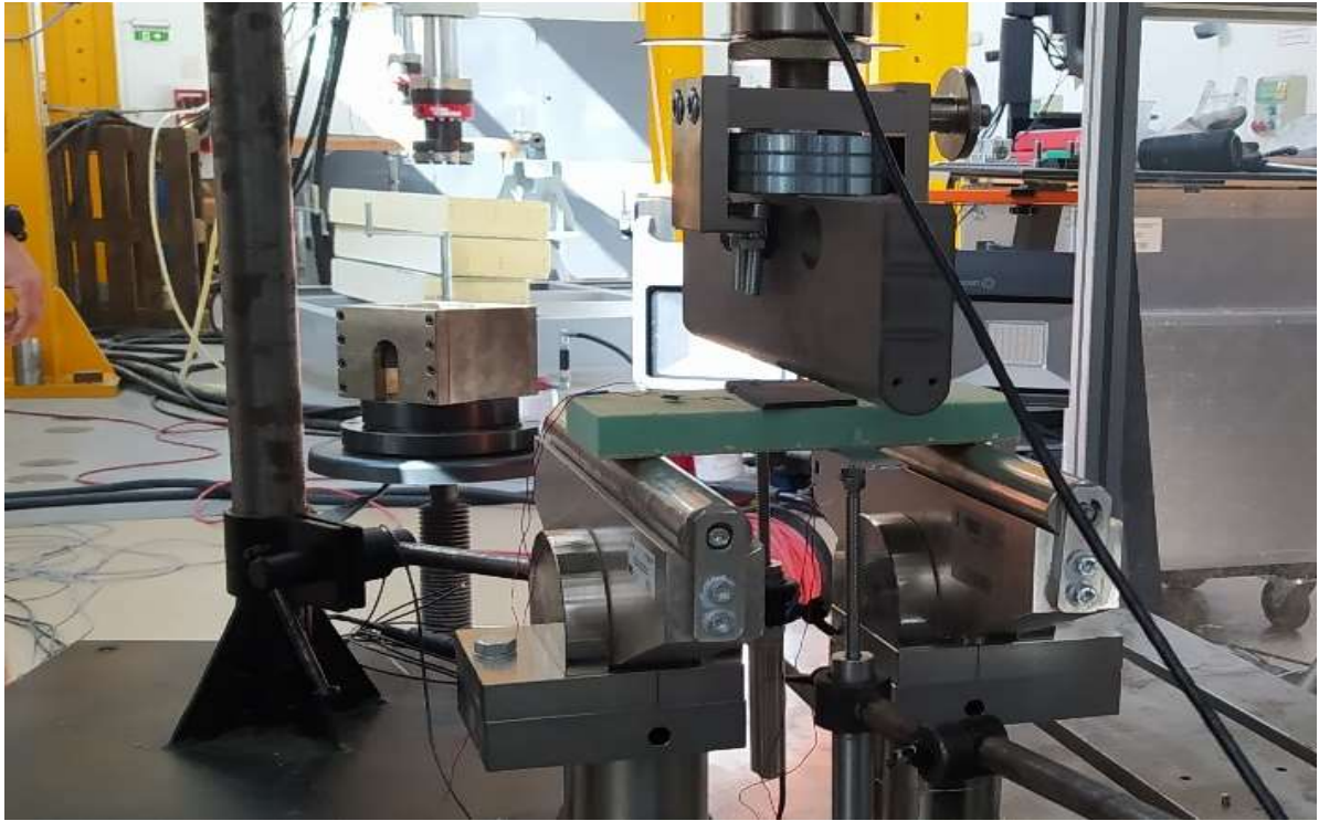
Slika 3.5 Uzorak pripremljen za testiranje na kidalici, te pozicioniran i spojen na mjerne uređaje.
