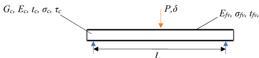
Slika 6.3 Shematski prikaz sendvič-panela, te fizikalne veličine potrebne za provjeru izvedivosti pokusa prema ASTM C393/393M standardu.
