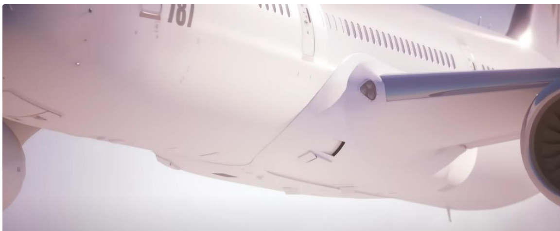
Slika 21 Ulazi za zrak na trupu zrakoplova [4]
