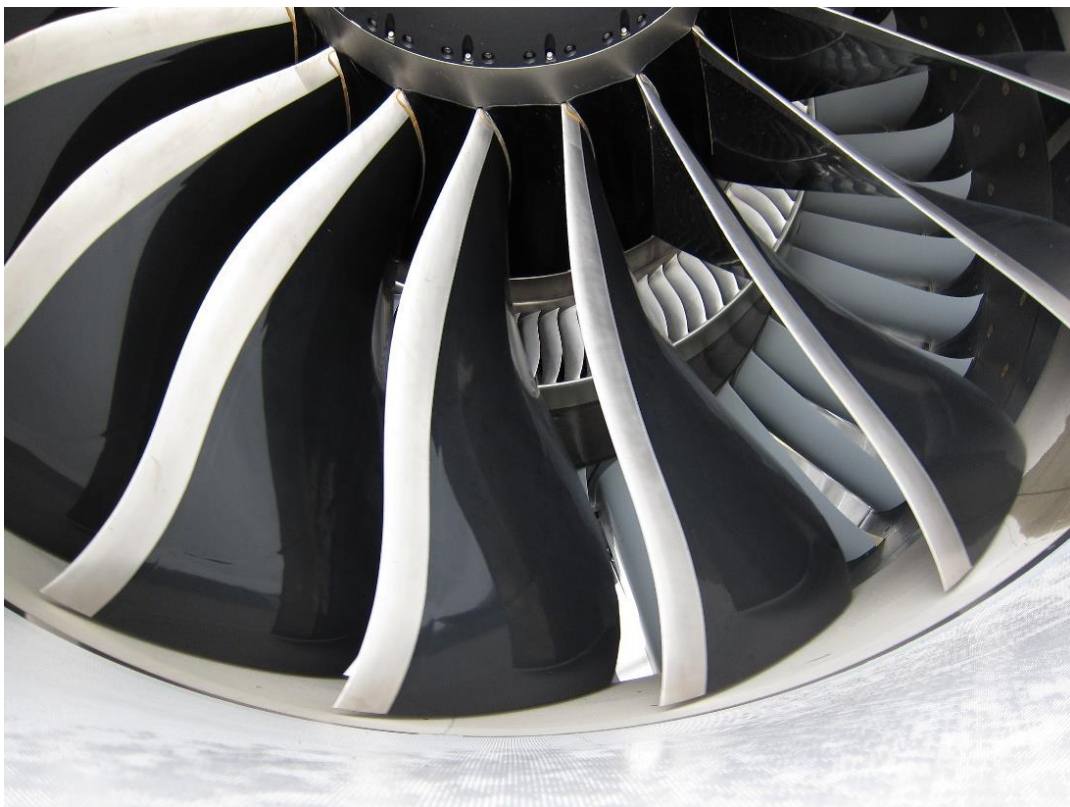
Slika 13 Lopatice turbine GENx motora
