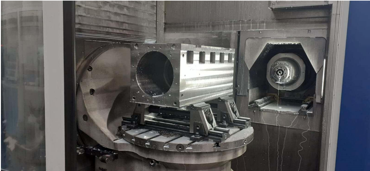
Slika 2.3. Glodanje na obradnom centru GROB
