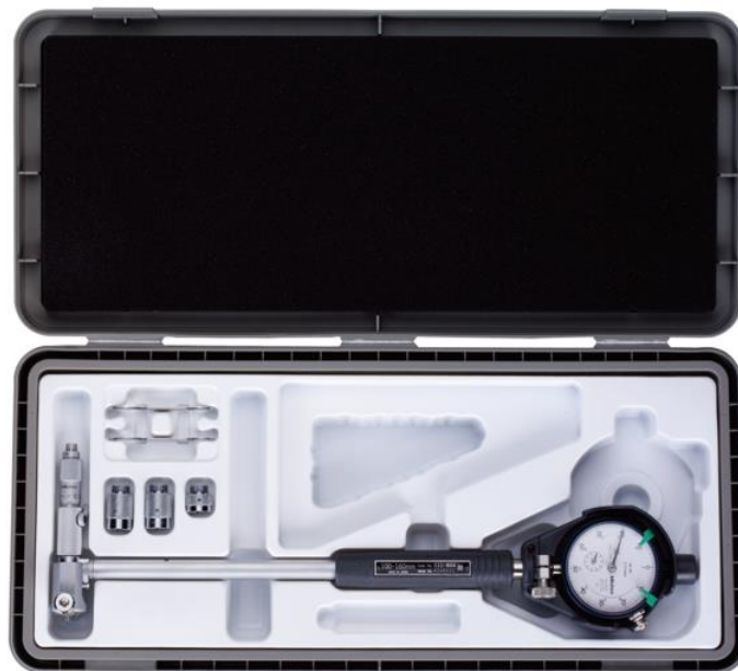
Slika 3.7. Komparator s mikrometerskom glavom [7]
