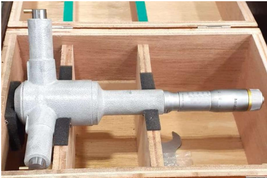
Slika 4.7. Klasično trokrako mikrometarsko mjerilo Mitutoyo
