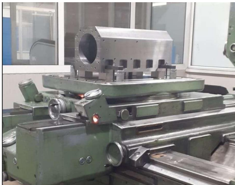
Slika 2.7. Kućište motorvretena nakon izrade
