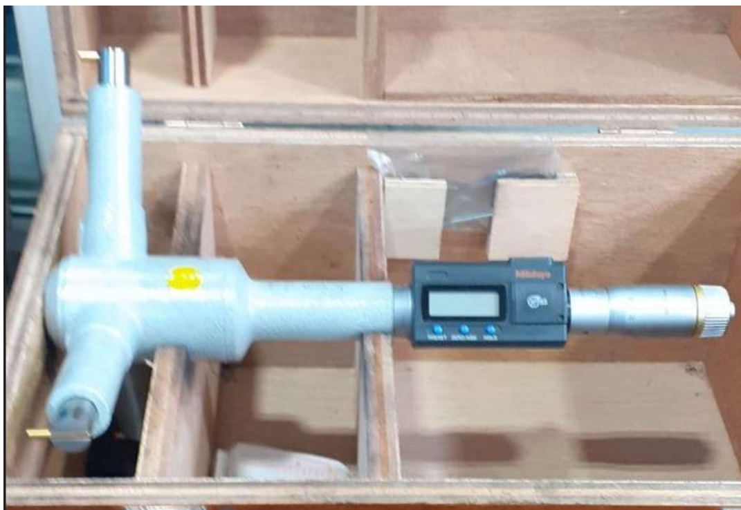
Slika 4.8. Digitalno trokrako mikrometarsko mjerilo Mitutoyo
