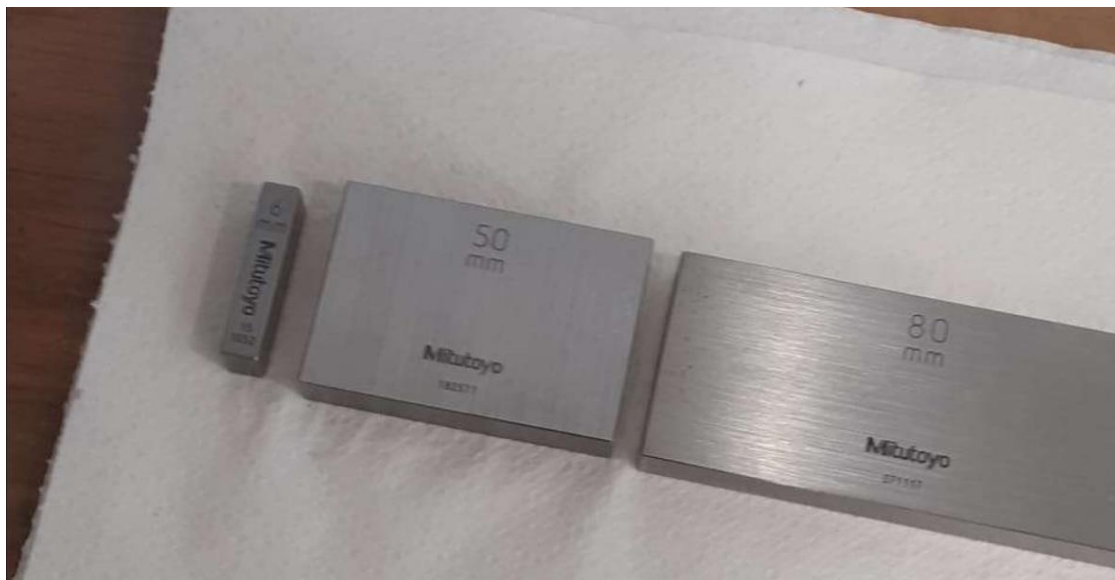
Slika 4.4. Mjerni etaloni Mitutoyo
