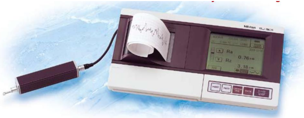
Slika 3.10. Uređaj za mjerenje hrapavosti [11]
