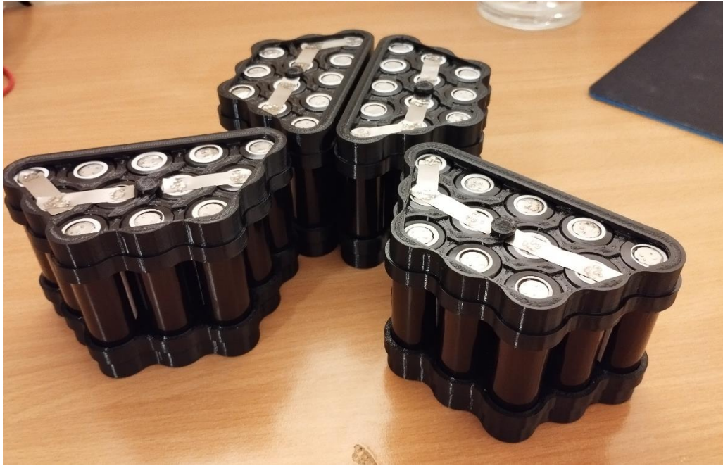
Slika 6.2 Moduli baterije u ronilici
