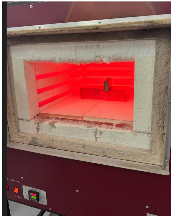
Slika 7.8 Uzorak u peći za kaljenje
