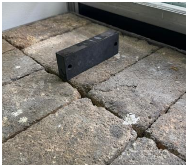
Slika 7.13 Ohlađenje uzorka na zraku
