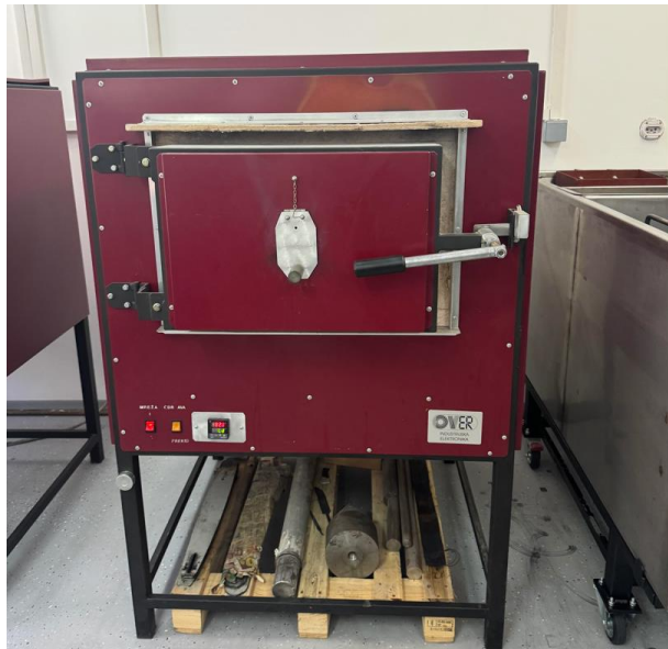
Slika 7.7 Peć za kaljenje
