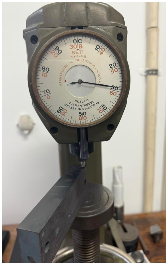
Slika 7.14 Mjerenje tvrdoće poslije popuštanja
