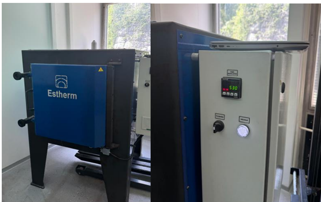
Slika 7.12 Peć za popuštanje (lijevo) i prikaz temperature popuštanja (desno)
