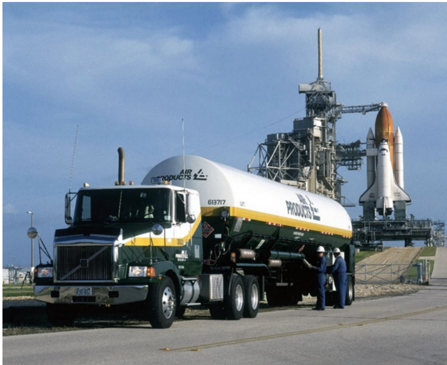
Slika 3.6 Spremnik za prijevoz tekućeg vodika [1].
