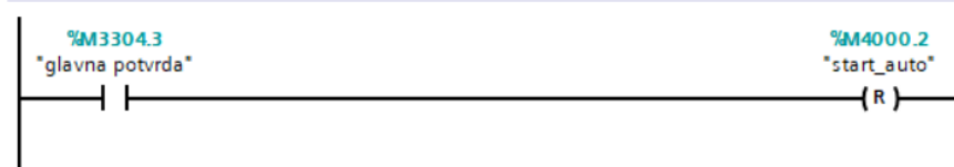
Slika 3.26. Logika za treći robot u automatskom režimu
