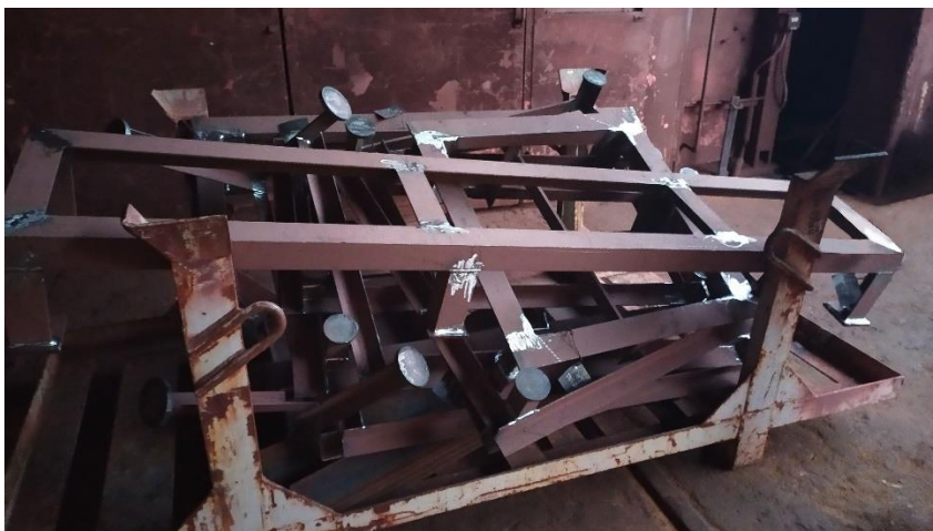
Slika 3.25. Primjer izbrušenih temelja
