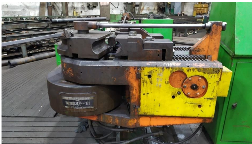
Slika 3.5. Savijačica cijevi sa unutarnjim trnom
