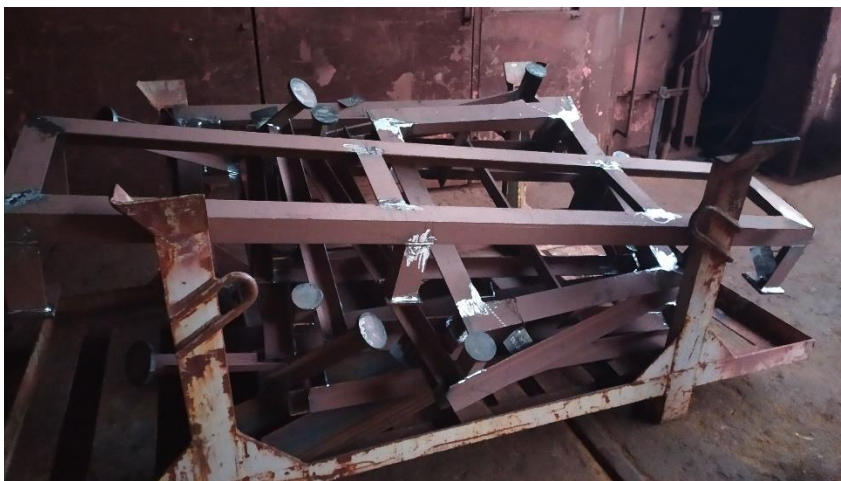
Slika 3.25. Primjer izbrušenih temelja
