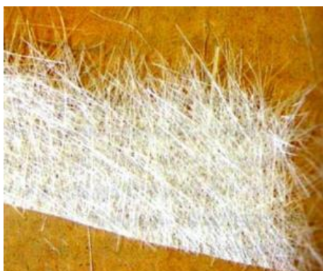
Slika 1.3. Pust od staklenih vlakana [2]
