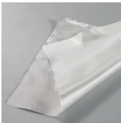
Slika 1.5. Sukno od staklenih vlakana s jednosmjernim nitnama [10]
