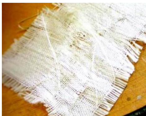
Slika 1.2. Konfiguracija pređe biaxial 0°/90° [2]
