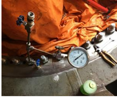
Slika 51. Tlačenje upravljačkog modula
