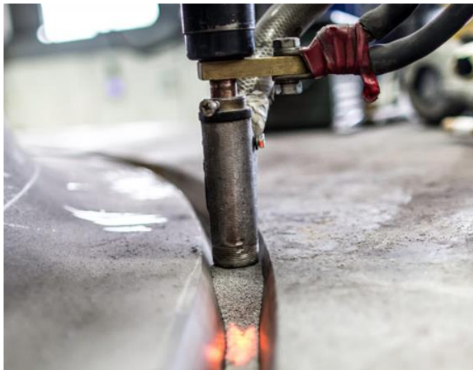
Slika 12. Zavarivanje pod praškom (EPP)
