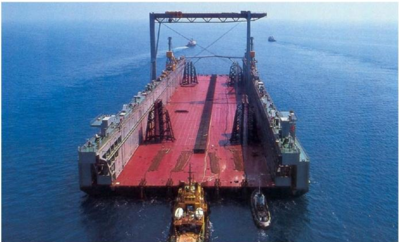
Slika 2.11. Plutajući dok za remont
