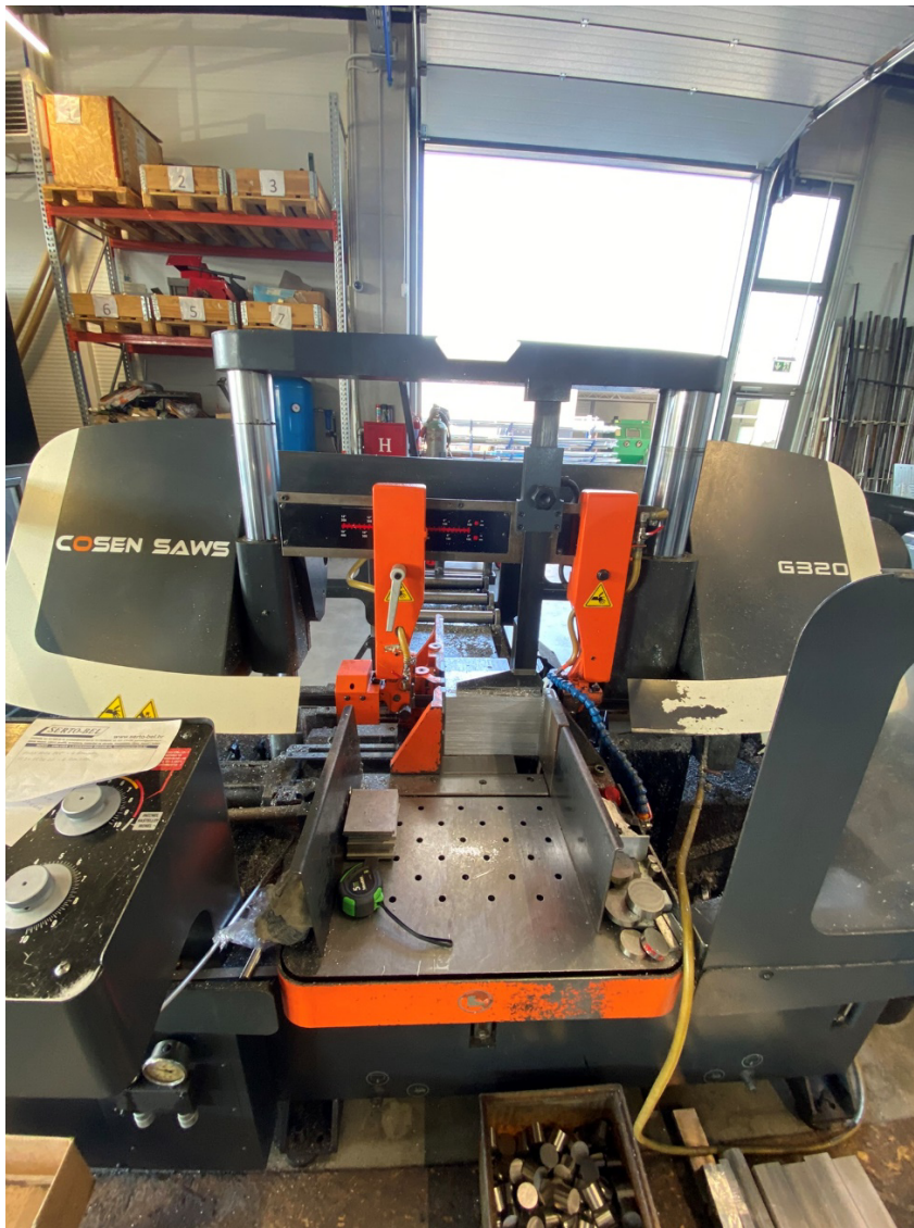
Slika 4.1.1. Rezanje sirovca Podloge na Cosen G320 pili
