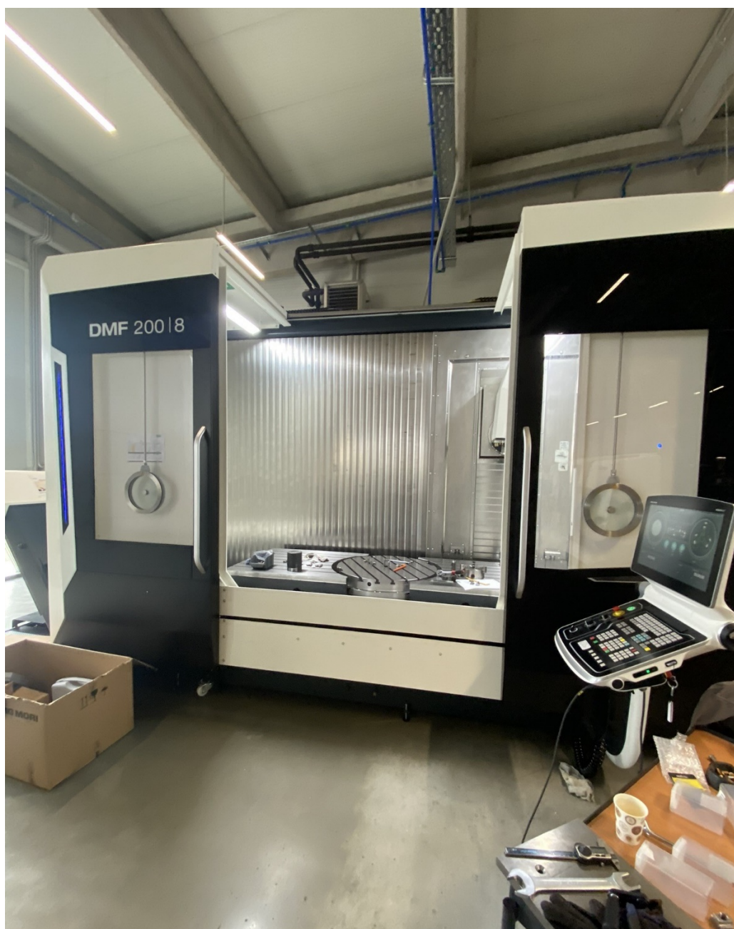
Slika 3.3.2. Petoosna glodalica DMF 200 | 8
