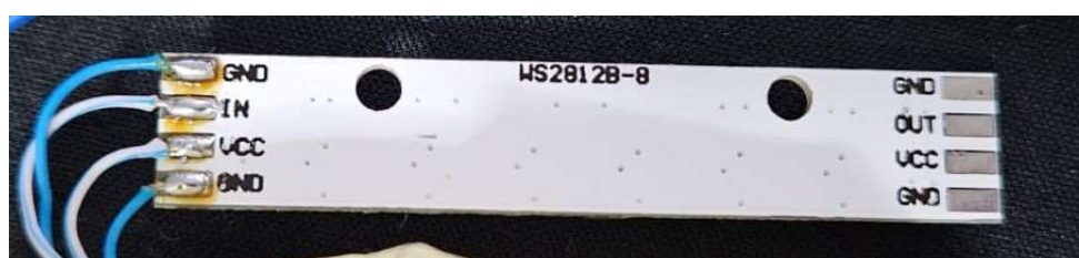
Slika 3.7. Prikaz WS2812B-8 modula sa stražnje strane.
