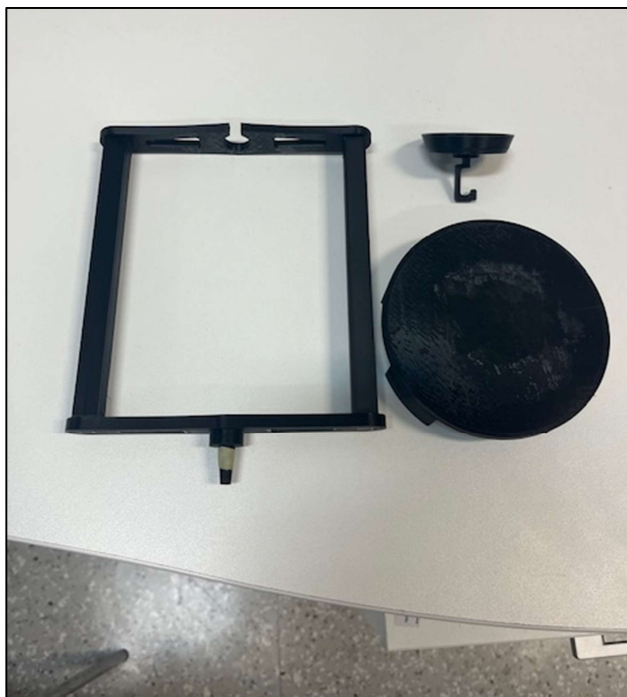
Slika 4.2 Isprintani dijelovi prije montaže
