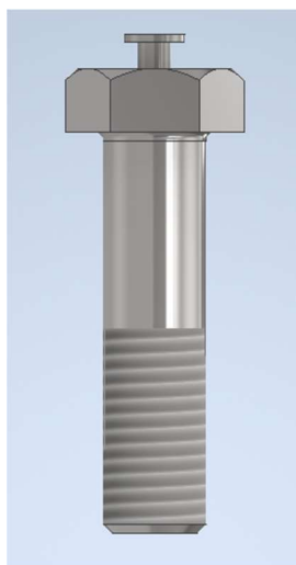
Slika 2.5. Vijak M12 sa svornjakom M4
