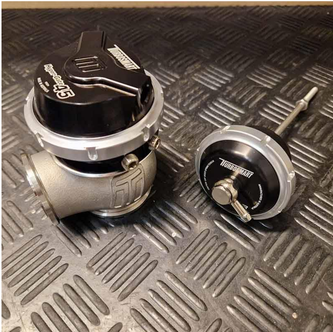
Slika 2.3. Unutarnji (lijevo) i vanjski(desno) wastegate ventil
