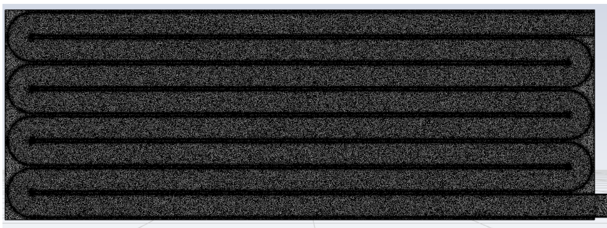
Slika 4.17 Tlocrtni prikaz numeričke mreže zmijolikog cjevovoda
